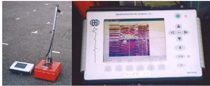
軽量・コンパクトな地中レーダSIR-3000(GSSI社製)
